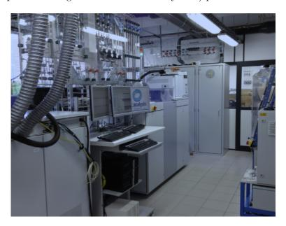
Cette plateforme permet la synthèse de systèmes catalytiques ainsi que leur test de performances en réaction et leur caractérisation à haut débit sur des robots. L'ensemble de cette chaine de développement (synthèse, caractérisation et test) est rassemblé sur un même site, ce qui fait que cet équipement est un outil unique. Cette plateforme pilotée par l'Unité de Catalyse et Chimie du Solide (UCCS UMR 8181) est localisée à l'Ecole Centrale de Lille.
